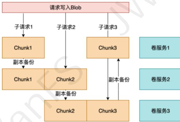
写入请求会根据 Blob 大小（如 20MB）拆分为多个 Chunk（4 个 5MB 的 Chunk）。
