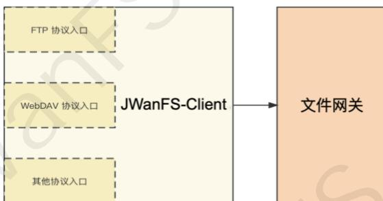
JWanFS-Client 将对文件系统的操作接口进行抽象，添加协议转换（协议解析与接口转换）层用于适配不同访问协议。用户通过简单配置即可以从 FTP、WebDAV、其他协议等读写 JWanFS 的数据，无需繁琐地重新编码对接。
